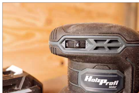
Mit diesem Stellrad wird die Schwingungszahl vorgewählt
