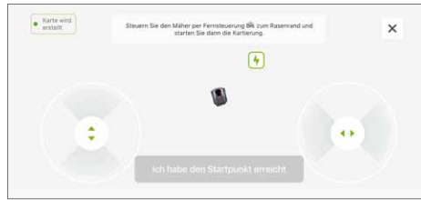
Im ersten Schritt gilt es, per Joystick-Funktion über die App eine virtuelle Karte zu erstellen
