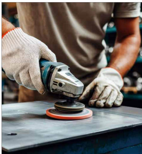
Mit Polierscheiben wird der Oberfläche der letzte Schliff gegeben, hierbei werden auch gern Polierpasten verwendet
