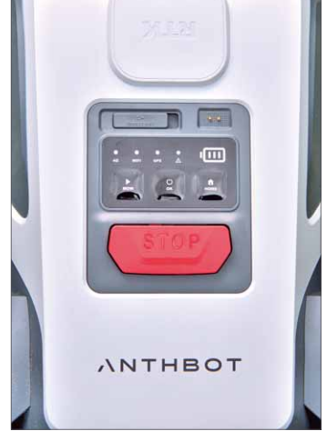
Die Bedienelemente am Roboter sind übersichtlich angeordnet und selbsterklärend. Rechts oben, über der Akkuladestands-Anzeige befindet sich der Regensensor
