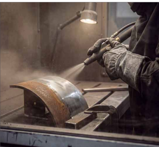
Kleinteile werden in speziellen Sandstrahl-Kabinen bearbeitet um den entstehenden Staub zu begrenzen
