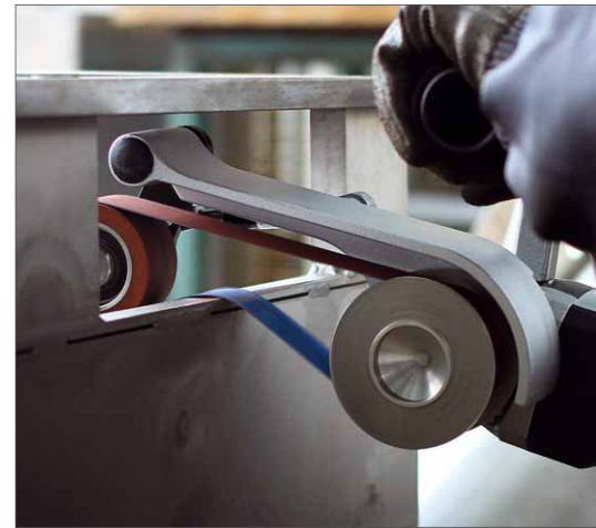
Längsschleifer eignen sich besonders, um Oberflächen schnell von Verschmutzungen und Rost zu befreien
