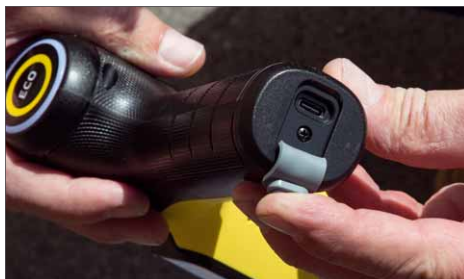
Unter einer Abdeckung am Griff findet sich die USB-C Ladebuchse
