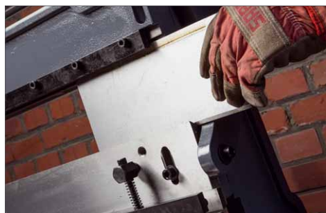
Um die Messer der Kantbank herausnehmen zu können werden diese erst in die Matrice gefahren, dann wird die Halteleiste gelöst und die Messer können entnommen werden
