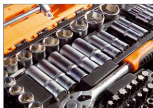
Langnüsse sind z.B. bei Bügelschrauben sehr praktisch
