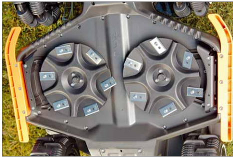
Zwei Mähscheiben mit jeweils sechs Wendemessern sind ein beeindruckendes Werkzeug
