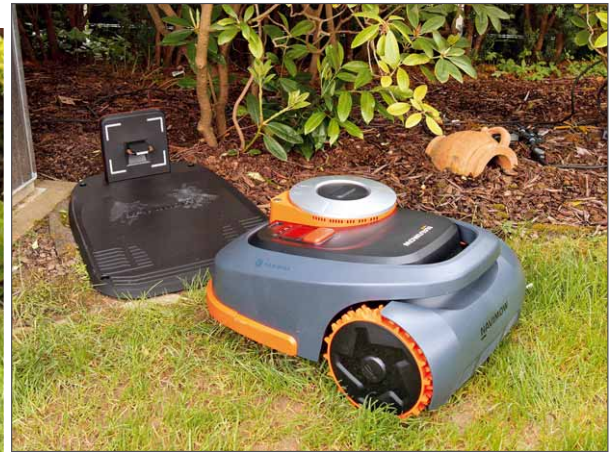
Die Ladekontakte befinden sich verdeckt in einer Öffnung vorn an der Maschine
