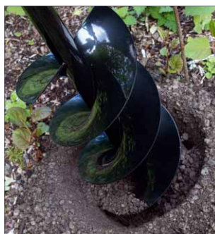
Der Bohrer hat einen Durchmesser von 20 Zentimetern und kann bis zu 80 Zentimeter tiefe Löcher bohren
