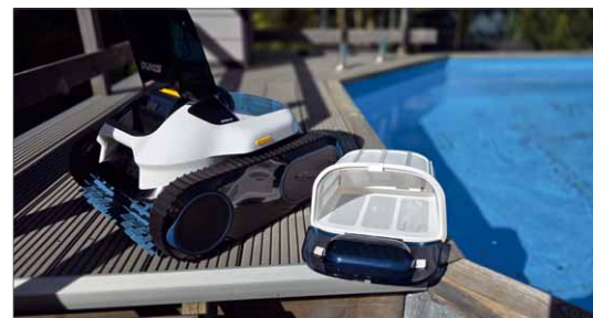
Um an den Filterkorb zu gelangen, wird einfach eine Klappe auf dem Gerät geöffnet
