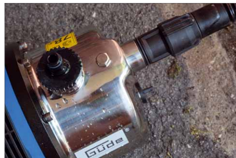
Der schwarze Kunststoffstopfen dient der Entwässerung im Winter. Die Edelstahlschraube der Entlüftung der Saugseite
