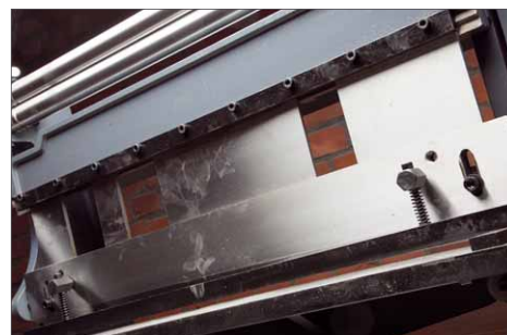
Um Innenkanten zu erzeugen, werden die Messer der Kantbank getrennt und neu auf das passende Maß zusammengeschoben
