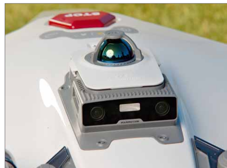
Mit Radar und Kameras navigiert der LUBA 3 sehr zuverlässig
