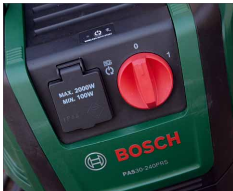
Die Automatikschaltung kann über die integrierte Steckdose oder bei Akku-Geräten per Bluetooth genutzt werden
