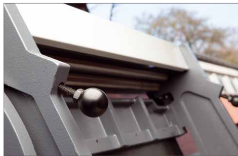
Der Radius der Biegemaschine wird über diese beiden Schrauben eingestellt
