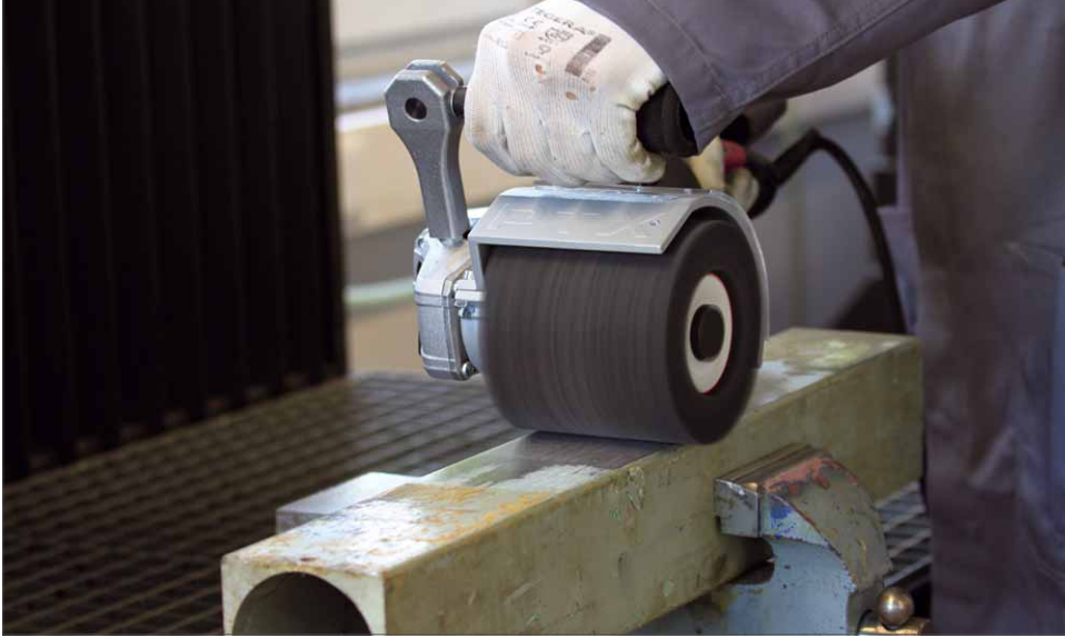
Ausgerüstet mit Zusatztools können Längsschleifer auch an schwer zugänglichen Orten eingesetzt werden
