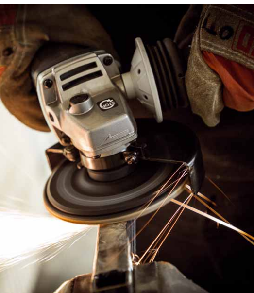
Stahl „blank machen“ als Vorbereitung zum Schweißen ist eine gängige Anwendung für Schruppscheiben
