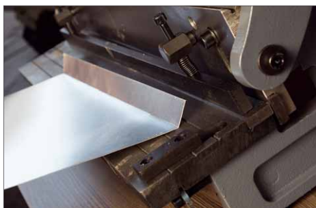
Bei kleineren Winkeln wird sich langsam herangestellt, indem zwischendurch der Winkel überprüft und ggf. mit der Bank nachgedrückt wird, bis es passt
