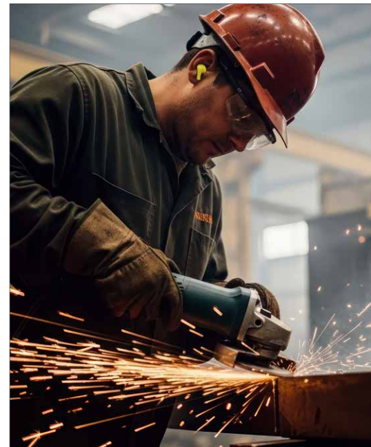
Mit Winkelschleifern können Materialüberstände einfach entfernt werden
