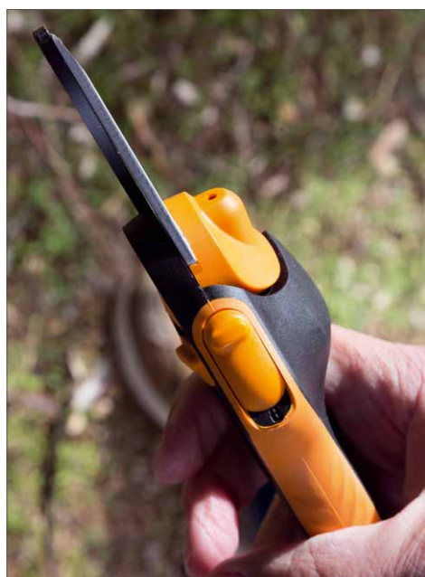
Die Verriegelung findet sich oben auf der Schere
