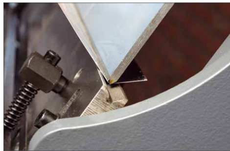
Die Kantbank kann Winkel bis 90 Grad erzeugen
