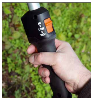
Unter dem rechten Griff befindet sich der Hauptschalter und oben der Funktionsumschalter
