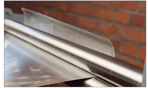
Der Rollenbieger kann ebenfalls Bleche mit einer Stärke von einem Millimeter biegen
