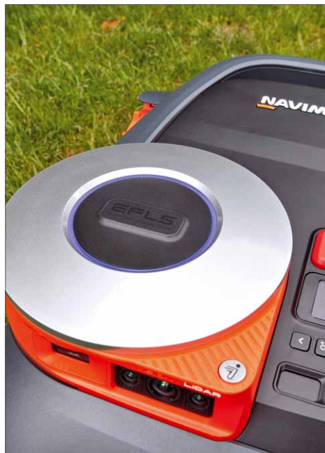
LIDAR und Kameras sind an der Maschine deutlich zu erkennen
