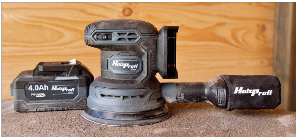
Der Akku steckt hinten an der Maschine über der Staubabsaugung
