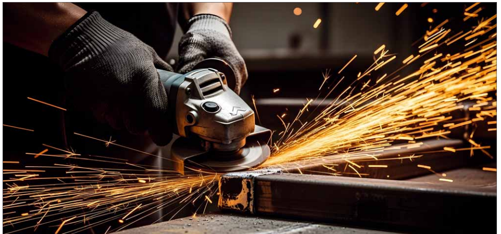
Grober Rost und Unebenheiten können sehr gut mit der Lamellenschleifscheibe entfernt werden
