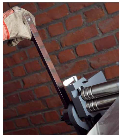
Die Länge des Betätigungshebels kann durch lösen und anziehen einer Knebelschraube schnell eingestellt werden
