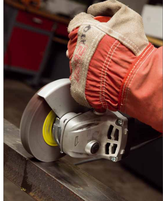
Den Winkelschleifmopp WSM 617 kann man direkt auf die Winkelschleiferwelle montieren
