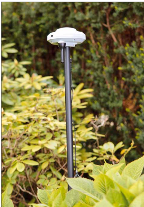
Zum Lieferumfang gehört auch eine Antenne, die dem Roboter bei der Orientierung hilft
