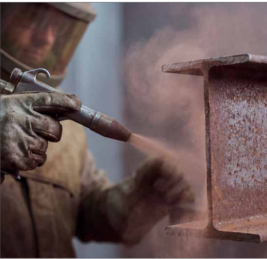
Zur effektivsten Rostentfernung gehört das Sandstrahlen von Stahl
