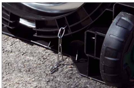
Für Sauger mit Metallbehälter ist die kleine Erdungskette vorgeschrieben
