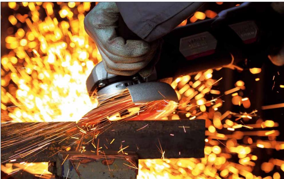
Wird eine Fächerscheibe stark beansprucht, lässt sie die Funken mehrere Meter weit fliegen
