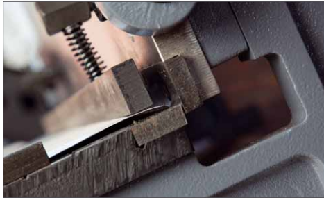
Der Niederhalter fixiert das Blech in der Schere
