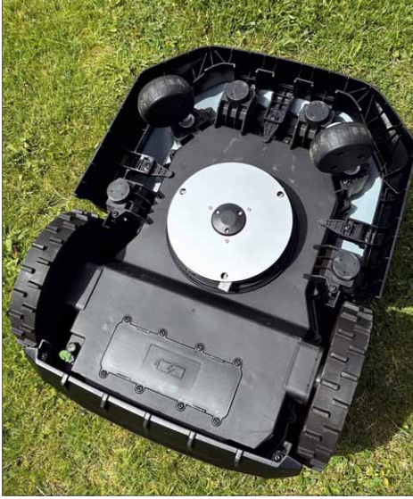
Auf der Unterseite sorgen drei Schleudermesser für zuverlässigen Schnitt
