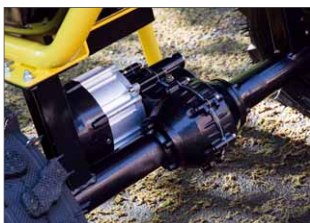
Dank des integrierten Differentials ist Kurven Fahren kein Problem
