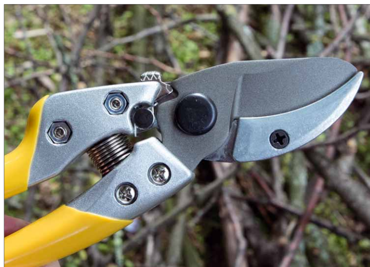
Die Verriegelung lässt sich durch kräftiges Zusammendrücken der Schere lösen
